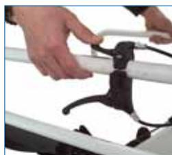
4) - Particolare del comando per la regolazione in altezza con molla a gas dell'intera struttura di sostegno.
