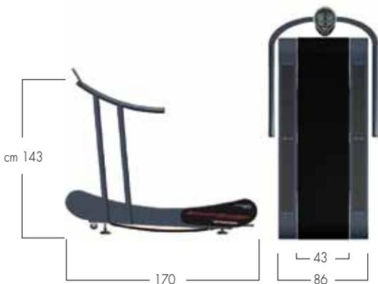
I camminatori Sprint 500 SL/LE dispongono della collaudata tecnologia della superficie di corsa lamellare, con trazione su cinghia dentata, per il massimo confort nella deambulazione. Sostenendo le lamelle su 108 cuscinetti a sfera ad altra precisione è possibile ottenere un'eccellente ammortizzazione, una migliore regolarità del passo e un minore consumo di corrente elettrica. La consolle di comando ha le stesse caratteristiche di quelle degli ergometri (vedi sezione 3, Riabilitazione).
